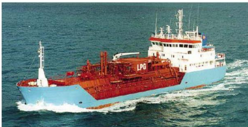
Figure 16. Un exemple d'un transporteur de GPL / \text{NH}_3 semi-pressurisé
