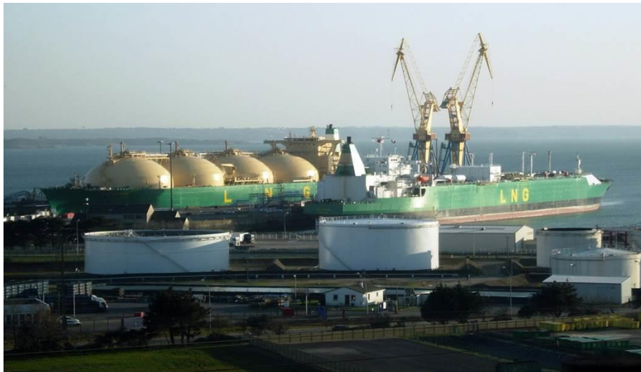
Figure 19. (Copyright Cedre). Vue globale de méthaniers (à cuves sphériques sur la gauche, prismatique sur la droite).
