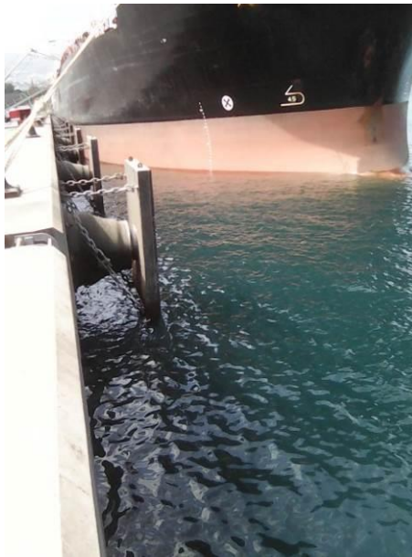
Figure 25. (Copyright Cedre). Illustration montrant l'effet de barrage d'un système de défenses fixes positionnées le long de la coque du navire.
