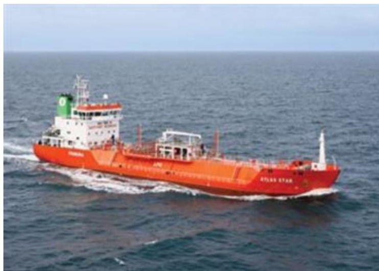
Figure 18. Exemple de transporteur de GPL/éthylène semi-pressurisé / totalement réfrigéré.
