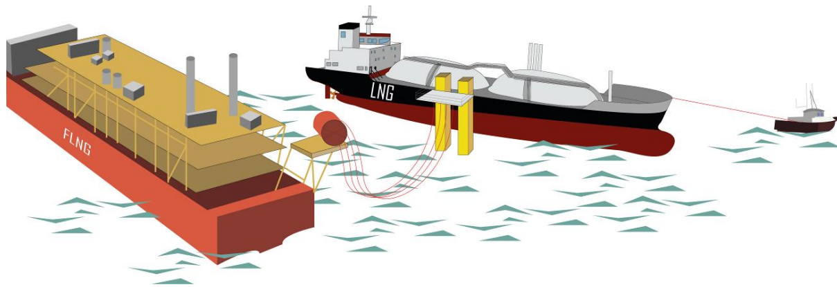
Figure 23. (Copyright Cedre). Déchargement de GNL en tandem. Bobine (orange) sur laquelle sont enroulées les canalisations souples pour le transfert.
