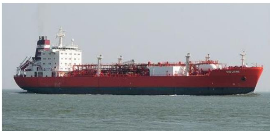
Figure 17. Un exemple de transporteur de GPL totalement réfrigéré.
