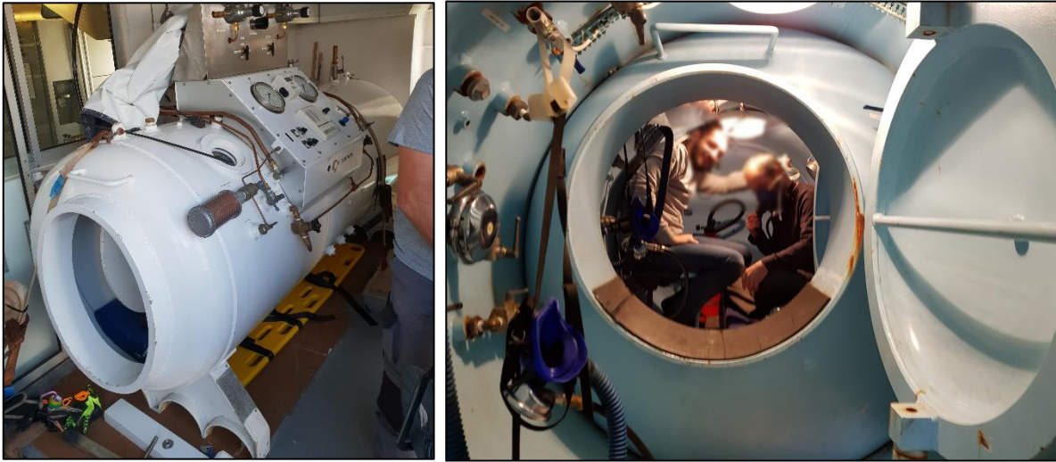
Fig. 20 : Caisson de chantier avec recompression sur site (source : Phymarex)
